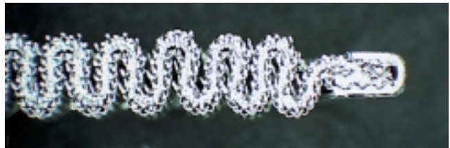
Vue en coupe d'un pack de filtration composé de plusieurs couches de toiles plissées avec bordure
