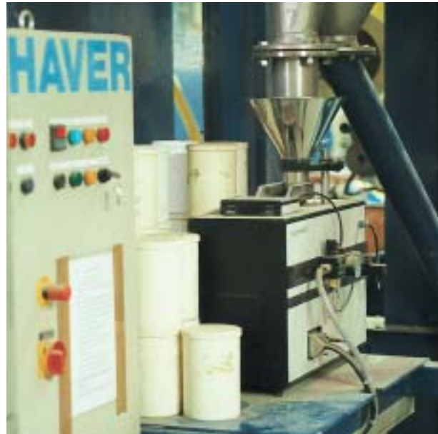
HAVER Steuerungsanlage für optisches Partikelmessgerät in der Katzenstreuproduktion
