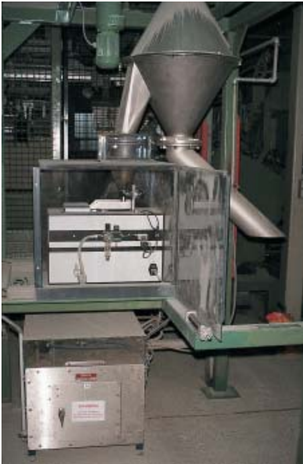
Onlineanlage mit Probenteiler und Rückstellprobensammler in der chemischen Industrie
